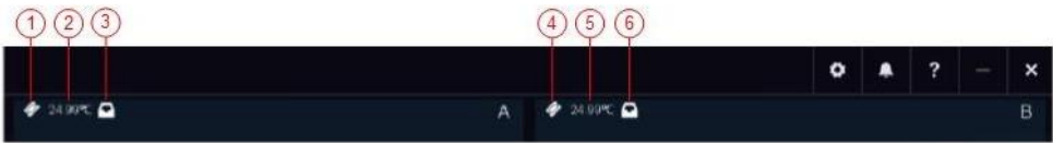
Рисунок 15. Описание значков состояния для проточной ячейки, температуры платформы проточной ячейки и картриджей
